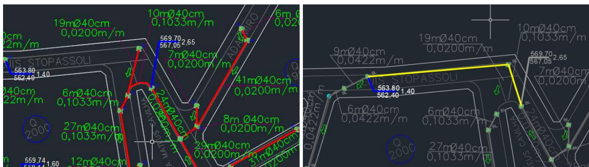
Figura 11 – Projeto de drenagem original e projeto executado
