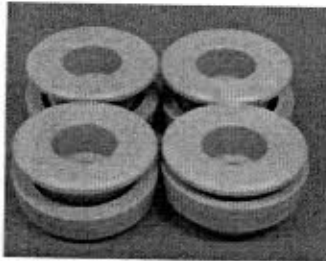
Ensaio de Radiação UV - Inicial
