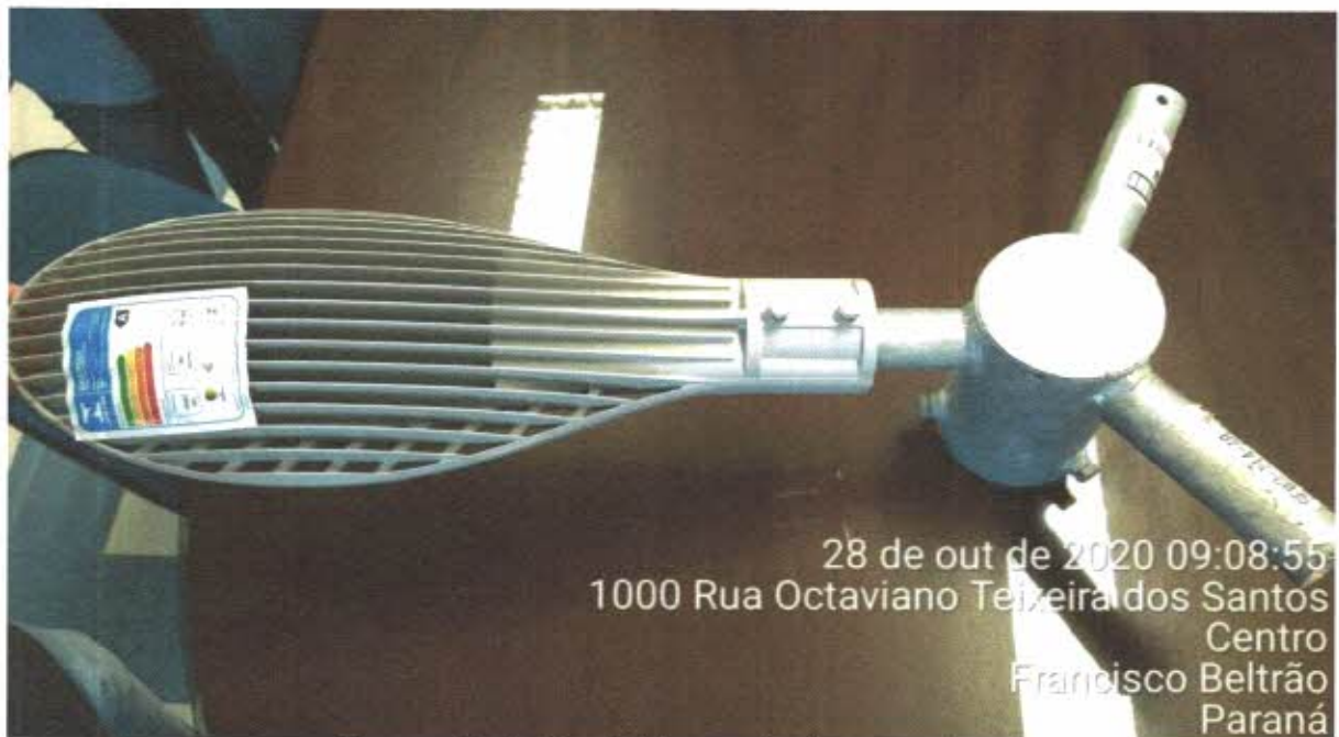
Fotografia 4 – luminária encaixada no suporte.
