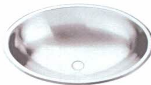
Imagem 28: Cuba em aço inox 304, 50x40x15 cm oval, com acabamento acetinado, a ser fixada em bancada de inox.
