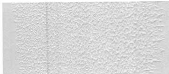
Imagem 13: Textura acrílica aplicada com rolo.
