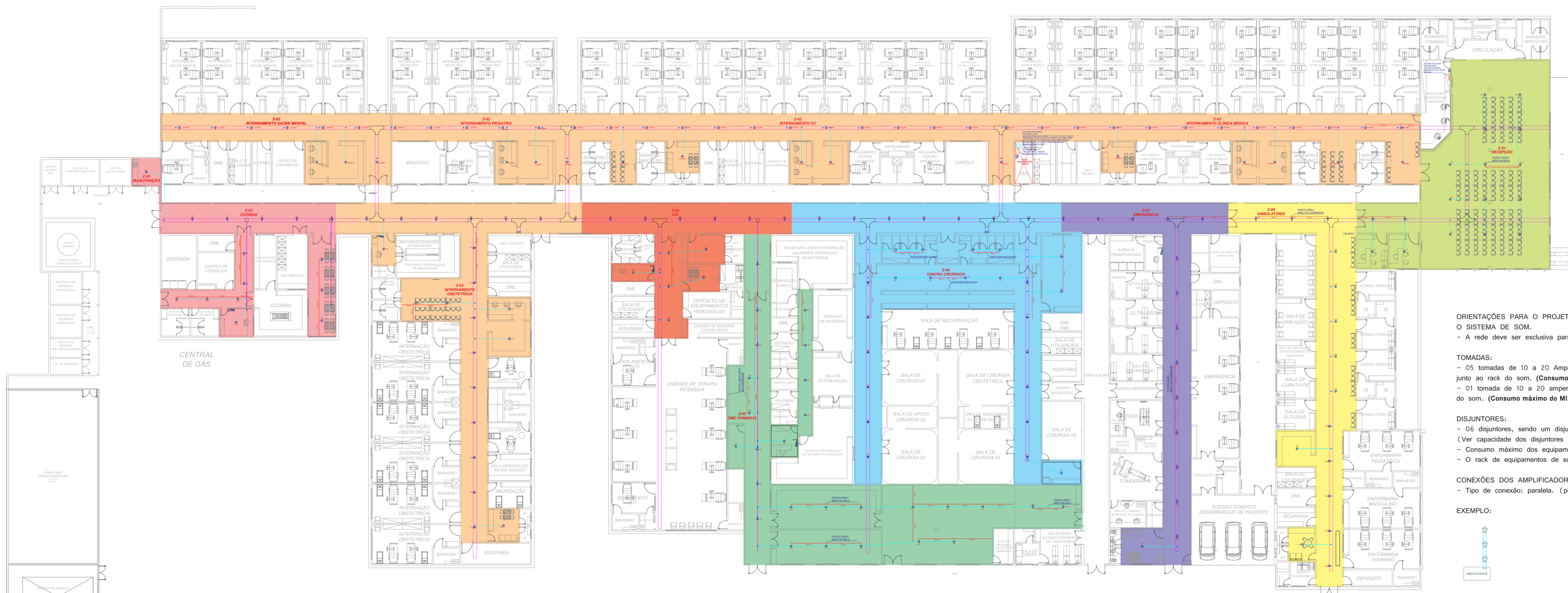
DISTRIBUIÇÃO E LOCALIZAÇÃO DAS ARANDELAS DE SOM E SEUS CABOS, RACKS DE EQUIPAMENTOS DE SOM E CABOS DE SINAL DE ÁUDIO
